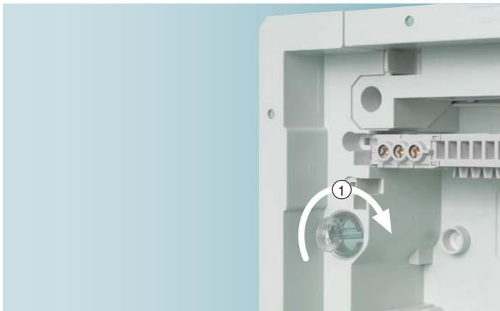
Все шкафы серии UK 500 допускают установку в полых стенах. Для крепления к полую стене необходим серийный набор UZ90P4, благодаря которому отпадает необходимость в установке под заднюю стенку шкафа дополнительных опорных элементов. Последующая сборка электрораспределительного шкафа также проста, как и его монтаж в стене.
