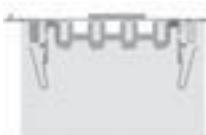
После установки изделия в коробку, оно надёжно и плотно фиксируется эластичными лапками.
