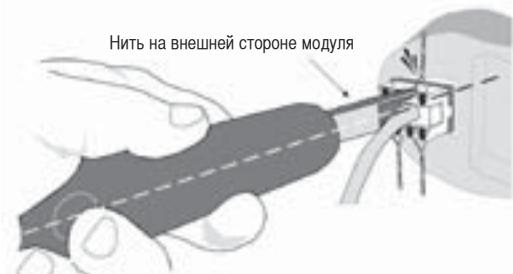
Примечание: Используйте инструмент для подключения типа AX100749 от NORDX/CDT, KRONE или подобный типу 110.
