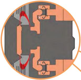
→ Запатентованный механизм "Double Break", обеспечивает быстрый разрыв дуги при К.З., что существенно снижает износ главных контактов и, соответственно, увеличивает электрический и механический ресурсы автоматов
