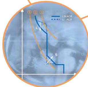
→ Все электронные блоки контроля и защиты имеют функцию "LSI", позволяющую выполнить регулировку срабатывания при перегрузке (L), коротком замыкании (S) и мгновенного отключения (I). Настройки этих характеристик позволяют обеспечить широкий диапазон селективности автоматического выключателя с другими защитными устройствами.
