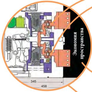
→ Вся линейка автоматических выключателей ETIPOWER имеет два отключающих контакта на каждом полюсе (запатентованный механизм "Double Break"), которые позволяют выдерживать ток короткого замыкания в течение 1 сек;
