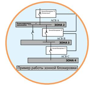
→ Автоматические выключатели ETIPOWER имеют систему "зонной блокировки", которая позволяет отключать ближайший к месту аварии выключатель независимо от заданной (настроенной) выдержки времени. Данная система позволяет значительно снизить тепловые и механические перегрузки возникающие в аварийном режиме, и воздействующие в течение задержки времени на всю электроустановку в целом
