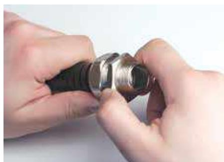
3. Посуньте гайку і кільце ущільнювача на край металорукава.
