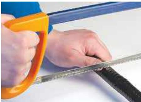
Металорукав можна відрізати за допомогою ножівки по металу, стрічкової пилки або кутової шліфувальної машинки.
