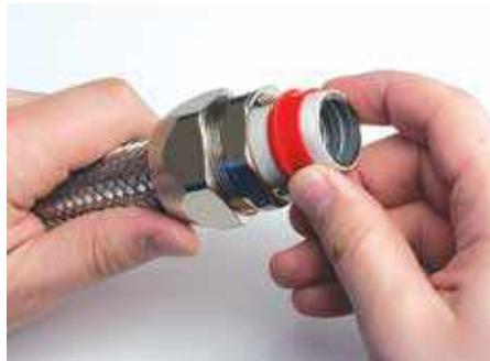
4. Одягніть затискне кільце ущільнювача червоного кольору на металорукав. Кільце ущільнювача одягається стороною з потовщенням під затискну гайку
