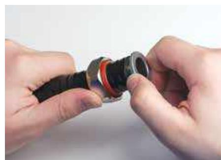
1. Спочатку слід одягнути на металорукав затискну гайку, потім затиснє ущільнююче кільце червоного кольору. Ущільнююче кільце одягається стороною з потовщенням під затискну гайку.
