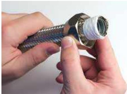
1. Спочатку слід одягнути на металорукав затискну гайку.
