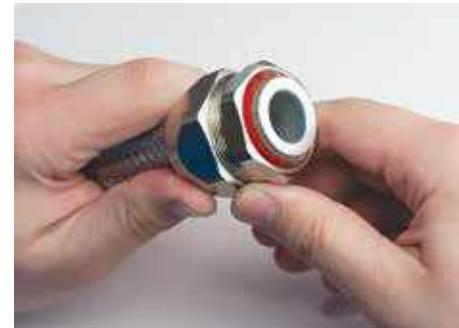
6. Посьуньте гайку, проміжний корпус і кільце ущільнювача на край металорукава.
