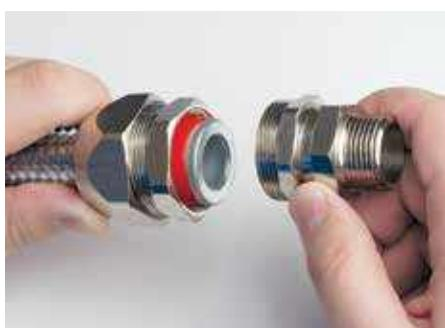
7. З'єднайте проміжний корпус і корпус муфти. Надійно затягніть за допомогою ключів гайку проміжного корпусу, а потім з'єднайте його з корпусом муфти для отримання заявлених ступеня IP і надійності фіксації обплетення металорукава.
