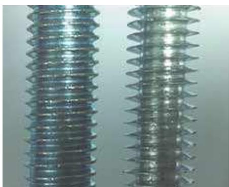
Варто звернути увагу на те, що найчастіше шпильки, які пропонують конкуренти, виготовляється з прутка меншого діаметру. В результаті номінальна площа перерізу шпильки зменшується за збереження зовнішнього діаметра різьби. Різьблення у своїй виходить характерно "гострої". На фото зліва зображені шпилька ДКС, виконана відповідно до DIN 975, і шпилька, виготовлена з прутка меншого діаметра, що мають один і той же зовнішній діаметр різьблення.
